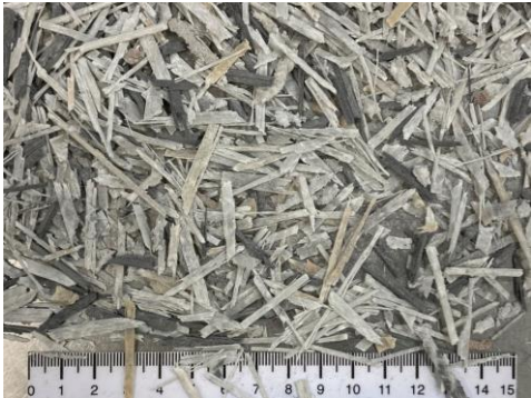
Composite « medium » mix 67% glass fiber composite 29% carbon fiber composite
