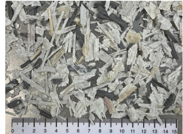
Composite « gross » mix 87% glass fiber composite 10% carbon fiber composite
